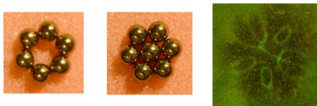
7. ábra Négy illetve öt mágnesgolyó és ez utóbbi mágneses tere
